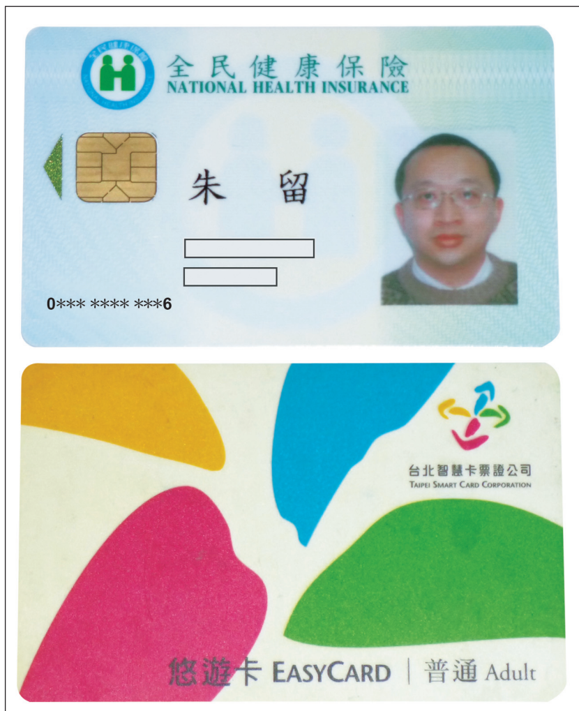
圖 2 接觸式晶片智慧卡與非接觸式 NFC 卡
