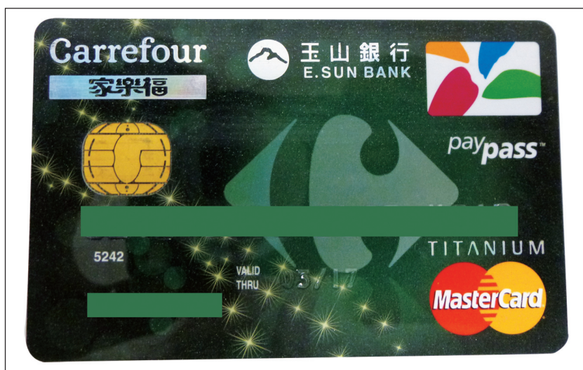
圖 3 接觸式晶片智慧卡與非接觸式 NFC 卡整合於同一張卡
